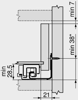
\* +1 мм при монтаже направляющей до сборки корпуса
